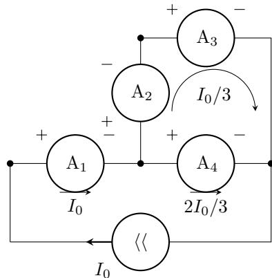
Пусть  $r$  — сопротивление амперметра. Определим сначала напряжение открытия диода  $U_D$ . Так как характер зависимости тока через чётвёртый амперметр от  $I_0$  меняется при  $I_0 = I_1$ , это значение соответствует тому, что напряжение на диоде достигло  $U_D$ , но ток через диод ещё равен нулю (переход от горизонтального участка ВАХ прибора к вертикальному). Запишем условие равенства
