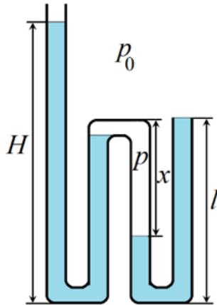
После заполнения водой второго слева вертикального участка, вода начнет стекать в третье колено, заполнит перемычку внизу между третьим и четвёртым и «отсечёт» воздух в третьем колене от атмосферного. Образуется воздушная «пробка», давление  $p$  внутри которой по мере заполнения четвёртого колена будет возрастать. Запишем условия равновесия (равенства давлений) для первого и второго вертикальных участков трубы:
