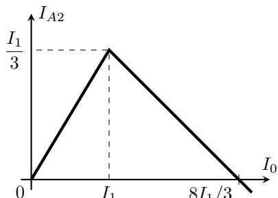
Способ 2 Расставим токи в цепи при  $I_0 > I_1$ , учитывая, что напряжение на диоде равно  $U_D$ . Пусть сила тока через второй амперметр равна  $I_{A2}$ . Тогда, исходя из равенства суммы напряжений на  $A_1$  и  $A_2$  напряжению на диоде, получим, что ток через первый амперметр
